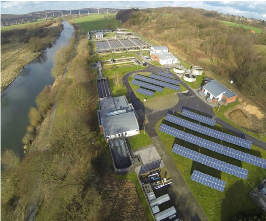
Hauptsächlich auf den Grundstücken von Kläranlagen (im Bild: Essen-Kettwig) hat der Ruhrverband seine bislang 13 PV-Anlagen mit einer Gesamtleistung von 1,2 MWh errichtet (Ruhrverband).
