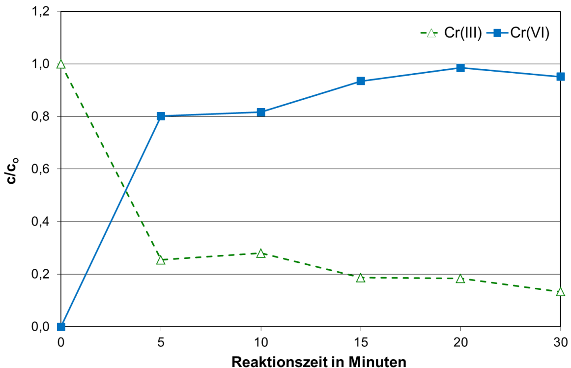
Abbildung 36: Gehalte an drei- und sechswertigem Chrom bei der Umsetzung von 1 µg/L Cr(III) in Trinkwasser mit 0,5 mg/L Chlordioxid (Original-pH)
