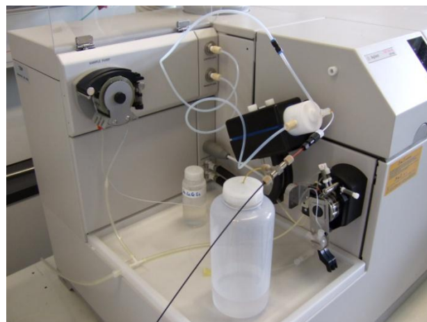
Abbildung 5: Detailaufnahme der Kopplung zwischen IC und ICP-MS
