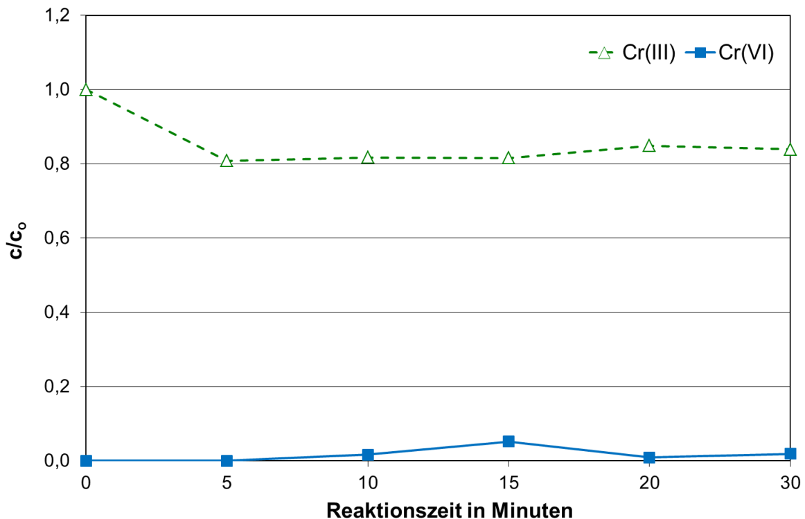
Abbildung 29: Gehalte an drei- und sechswertigem Chrom bei der Umsetzung von 1 µg/L Cr(III) in Flusswasser mit 0,25 mg/L Chlor (Original-pH)
