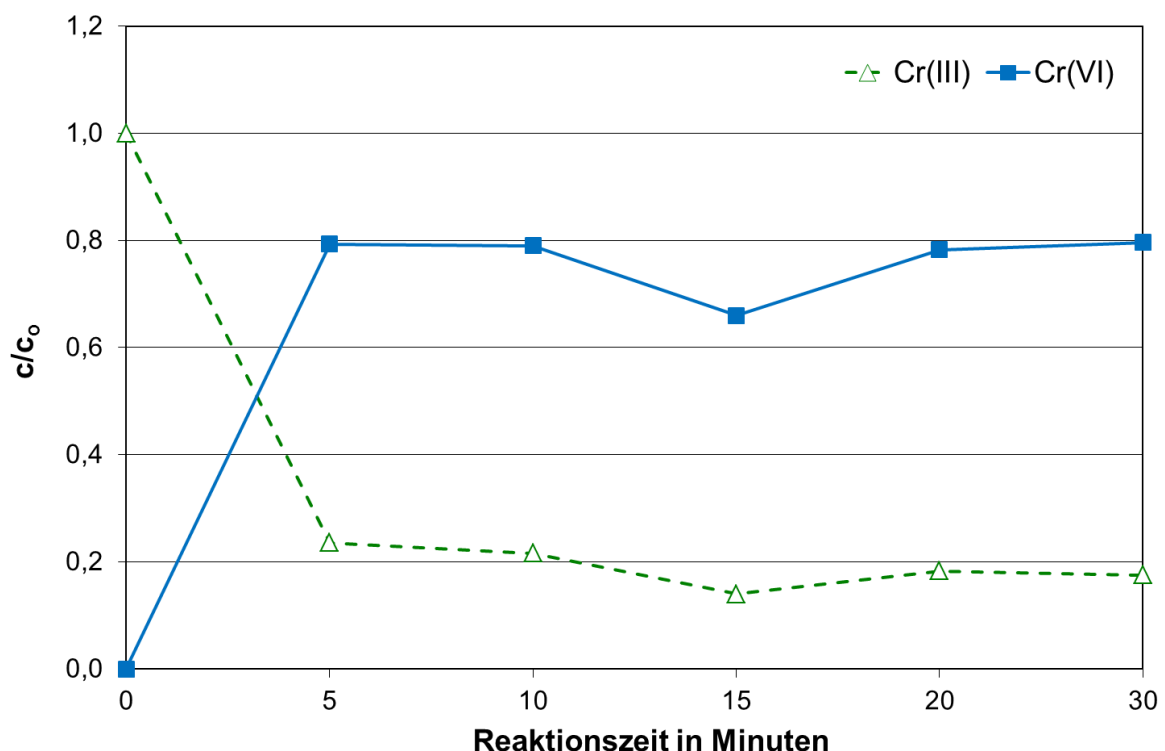
Abbildung 30: Gehalte an drei- und sechswertigem Chrom bei der Umsetzung von 1 µg/L Cr(III) in Trinkwasser mit 1 mg/L Chlor (Original-pH)
