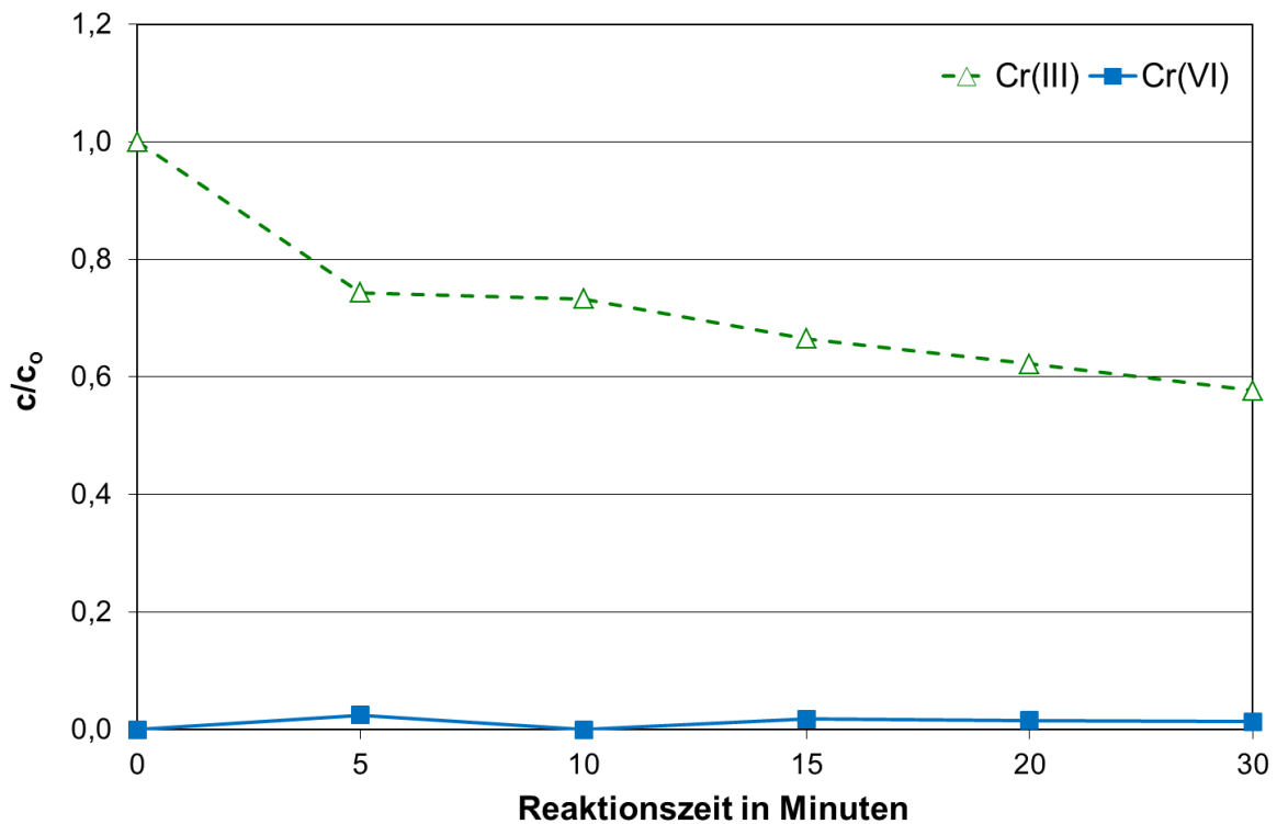
Abbildung 27: Gehalte an drei- und sechswertigem Chrom bei der Umsetzung von 1 \mu\text{g/L} Cr(III) in MilliQ-Wasser mit 0,25 mg/L Chlor (Original-pH)
