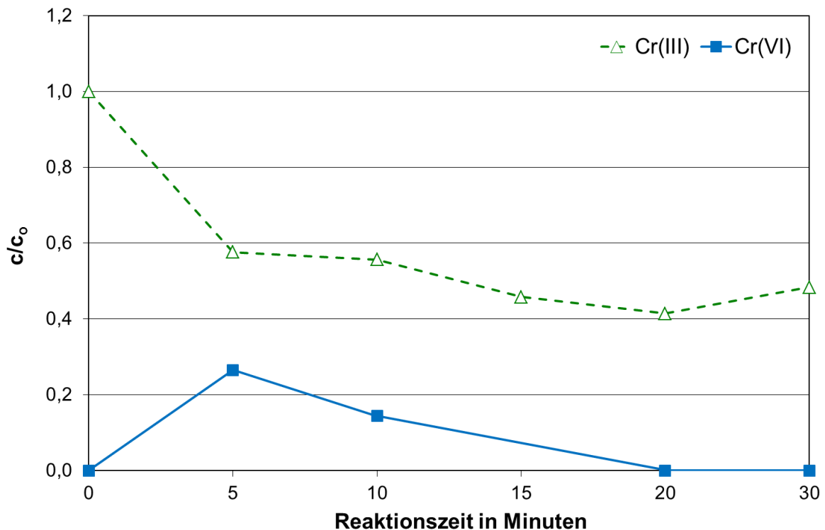
Abbildung 32: Gehalte an drei- und sechswertigem Chrom bei der Umsetzung von 1 µg/L Cr(III) in Trinkwasser mit 0,25 mg/L Chlor bei pH 9
