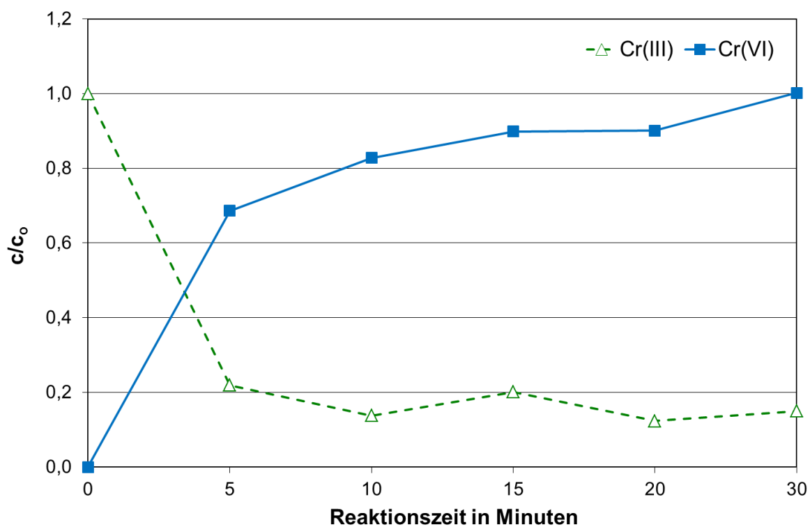
Abbildung 34: Gehalte an drei- und sechswertigem Chrom bei der Umsetzung von 1 µg/L Cr(III) in Trinkwasser mit 0,25 mg/L Chlordioxid (Original-pH)
