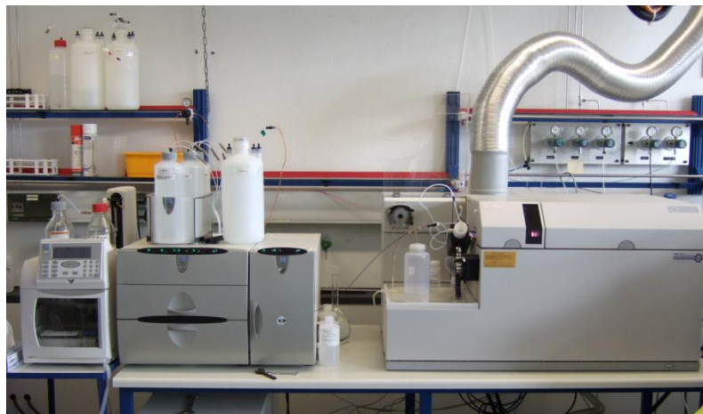
Abbildung 4: Realisierung der IC-ICP-MS-Kopplung im Labor
