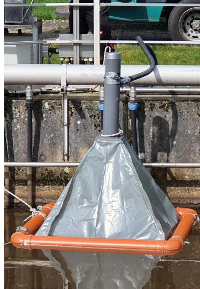
FTIR-Messung in der Gasphase, durchgeführt vom LANUV als Messkampagne
