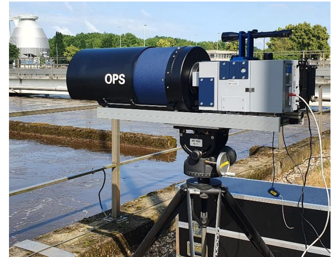
FTIR-Messung in der Gasphase, durchgeführt vom LANUV als Messkampagne
