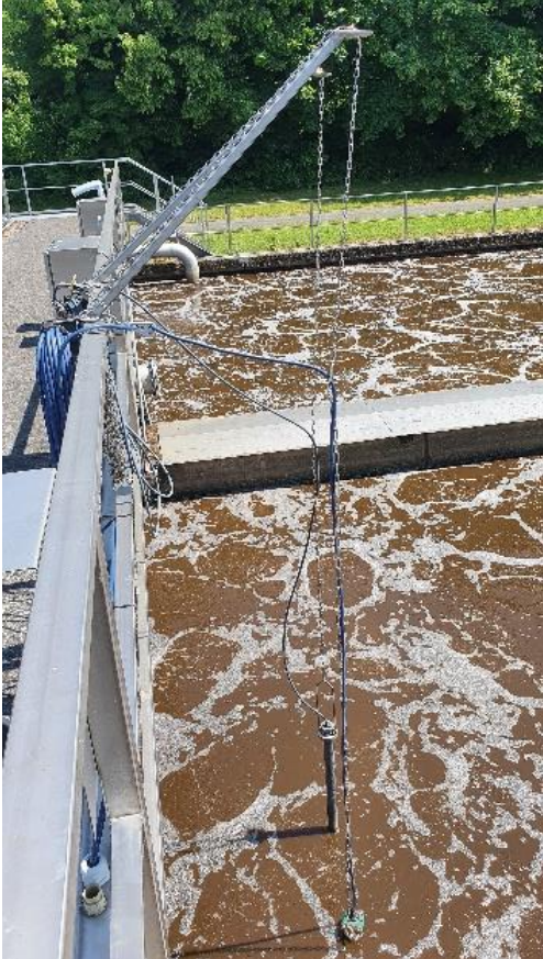
Kontinuierliche Sensor-Messung (Unisense A/S) in der Flüssigphase
