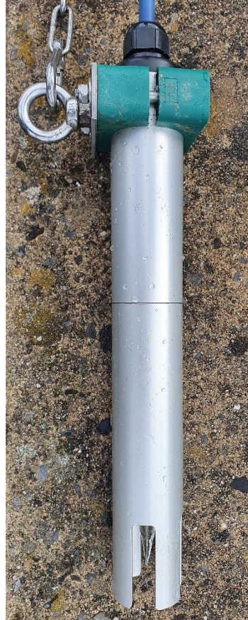
Kontinuierliche Sensor-Messung (Unisense A/S) in der Flüssigphase
