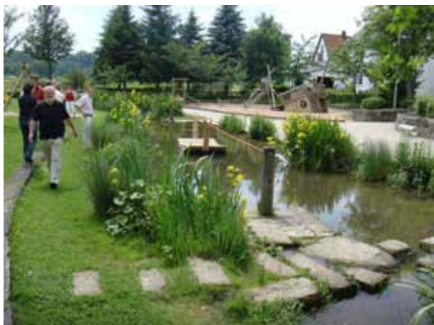
Bild 25: Zwei „Wasserspielplätze“ an einem Bachlauf. Links: Durch Bach gespeist, aber im Nebenschluss bzw. außerhalb des Stromstriches angelegt um eine mögliche Hochwassergefährdung zu minimieren. Rechts: Direkt an einem Quellbach (Fotos: R. SCHÖBERER)
