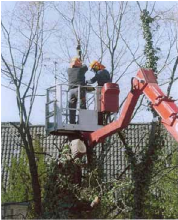
Bild 11: Abtragen eines überalterten Baumes mit einem Hubsteiger im Bereich eines Hauses (Foto: E. STÄDTLER)
