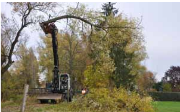
Bild 38: Auch mit einem kombinierten Greif- und Schneidegerät kann man bruchgefährdete Bäume entlang von Wegen zurückschneiden (Fotos: Th. PAULUS)
