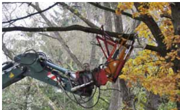
Bild 38: Auch mit einem kombinierten Greif- und Schneidegerät kann man bruchgefährdete Bäume entlang von Wegen zurückschneiden (Fotos: Th. PAULUS)
