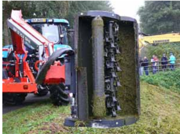
Bild 23: Bei Mulcharbeiten können durch die schnelle Rotationsbewegung der Mulchwelle Fremdkörper umhergeschleudert werden. (Fotos: B. WALSER)
