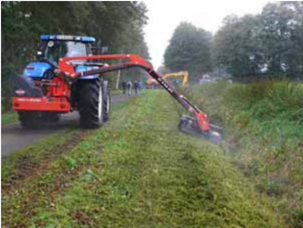
Bild 23: Bei Mulcharbeiten können durch die schnelle Rotationsbewegung der Mulchwelle Fremdkörper umhergeschleudert werden. (Fotos: B. WALSER)
