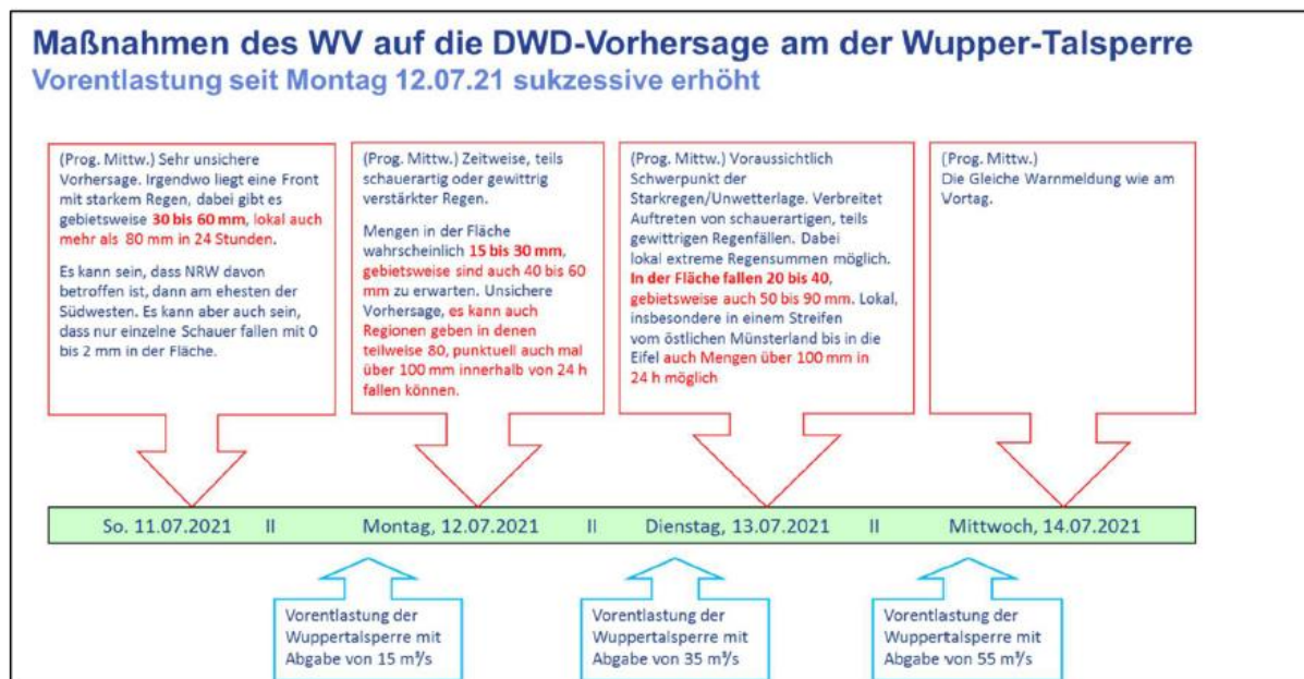
Abb. 13: Vorentlastungsschritte der Wupper-Talsperre vom 12.-14. Juli 2021 (Wupperverband, 2021)
