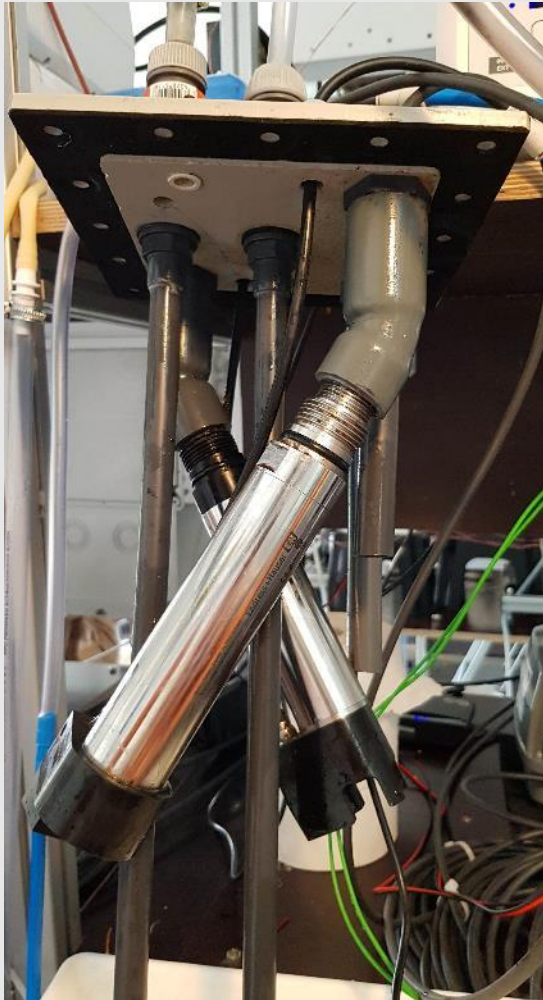
Abb. TS und O 2 Sonde im Deckel
