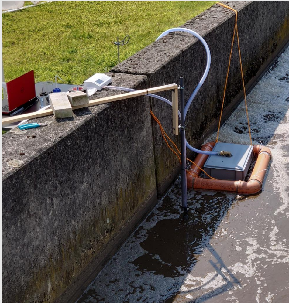
Abb.: Messaufbau KA Dorsten – Nitrifikation, Messung Gas und Flüssigkeit mit Unisense-Sonde
