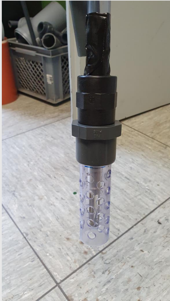
Abb. 2.7: N 2 O Messung in der Flüssigphase mit Einsatz einer Unisense Sonde
