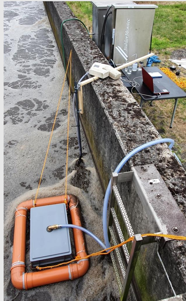
Abb.: Messaufbau KA Dorsten – Nitrifikation, Messung Gas und Flüssigkeit mit Unisense-Sonde
