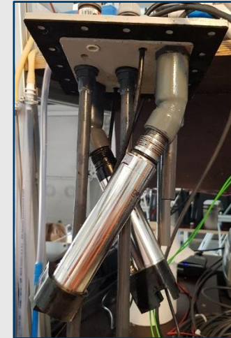
Abb.: Im Deckel verbaute Messsensorik ( O_2 , TS, N_2O ), Ablauf und Gasausgang
