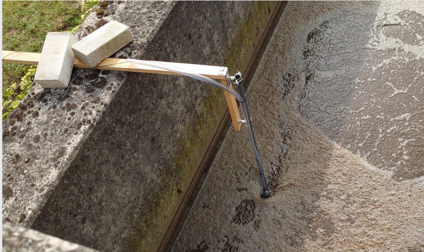
Abb. 2.7: N 2 O Messung in der Flüssigphase mit Einsatz einer Unisense Sonde
