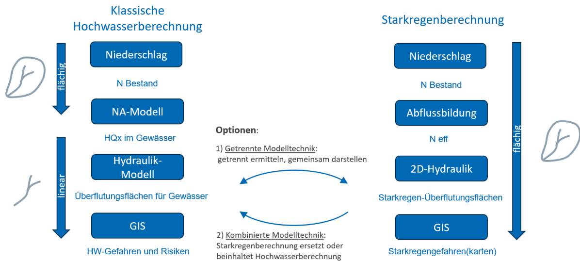
Abbildung 6: Gegenüberstellung von Hochwasser- und Starkregenergebnissen und Möglichkeiten der Zusammenführung für kleine Gewässer (Fall A)
